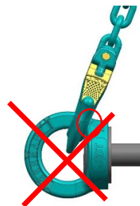
Figure 4 : Une sollicitation avec un angle supérieur à 90° n'est pas autorisée si le dispositif d'ancrage s'appuie sur la charge ou sur le corps du Ring Point.
