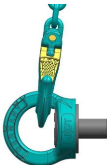
Figure 3 : Une sollicitation avec un angle supérieur à 90° est autorisée si le dispositif d'ancrage accroché ne s'appuie ni sur la charge, ni sur le corps du Ring Point.
