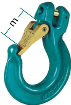
Das Hakenmaul darf max. 10 % größer sein, als das Nennmaß  $>m<$  im Katalog. Der Verschleiß am Bolzendurchmesser darf max. 10 % betragen.
