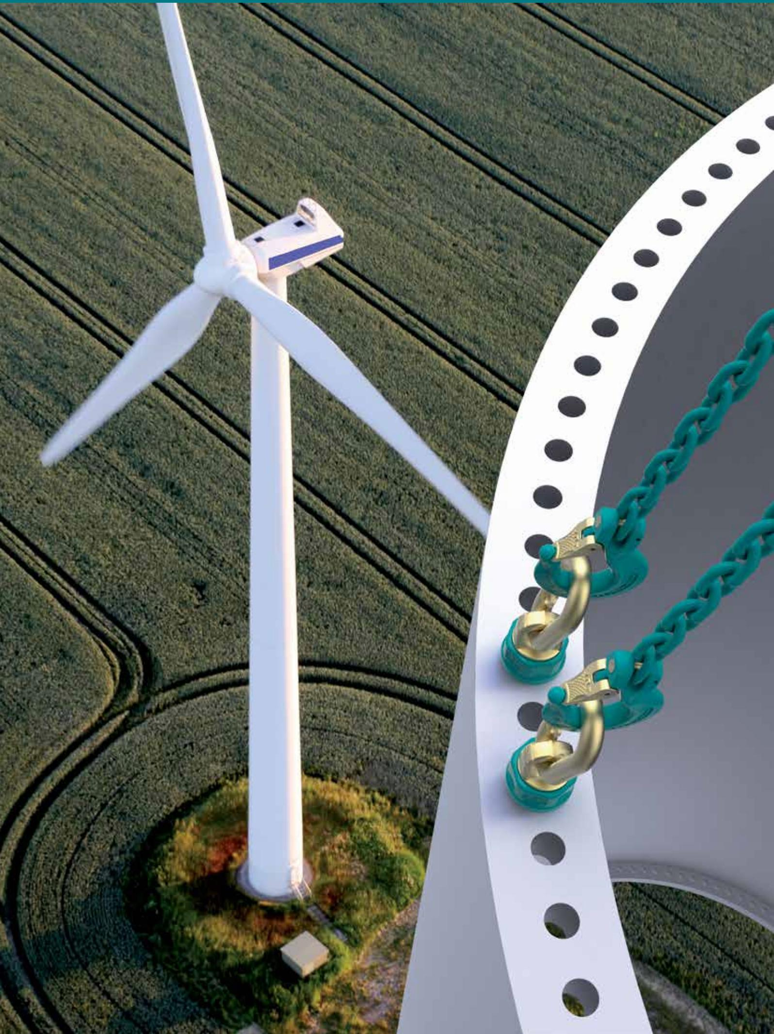
Durch das modulare Baukasten-System von JDT können die Montagen mit einem perfekt austarierten Gewicht vorgenommen werden. Das spart nicht nur Zeit, sondern verringert zudem das Risiko von Unfällen. Die Haltesysteme dienen dabei gleichzeitig zur Ladungssicherung.
