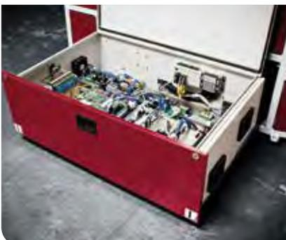
Die Steuereinheit ist platzsparend sowie dreck- und spritzwassergeschützt in einer voll ausziehbaren Schublade leicht zugänglich unter der Paletteneinheit angebracht.
