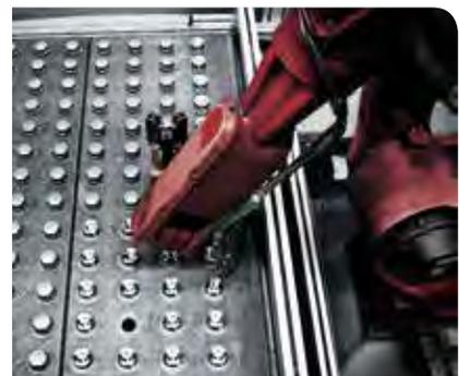
Abschließend legt der Roboter das Wirbelkörpergehäuse auf der Palette ab und nimmt direkt einen neuen Rohling auf.
