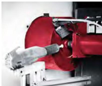
Der Greifer dreht das Werkstück gleichmäßig, während eine definierte Menge Pulver aufgetragen wird.
