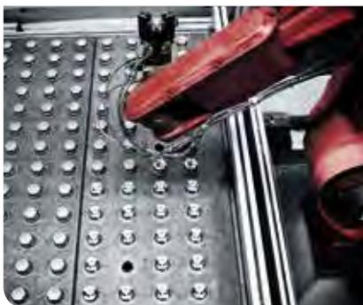
Der Roboter nimmt mit dem 3-Backen-Greifersystem den Wirbelkörperrohling auf und begibt sich in Warteposition.
