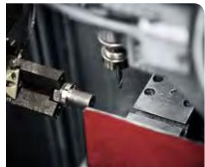
Direkt im Anschluss wird der Wirbelkörper aus der Drehmaschine der Bohreinheit zugeführt ...
