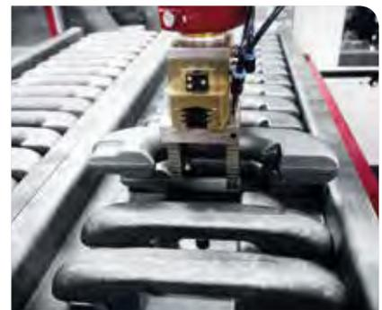
Mit einem speziell auf das Bauteil abgestimmten Greifer nimmt der Roboter den Rohling sicher auf.
