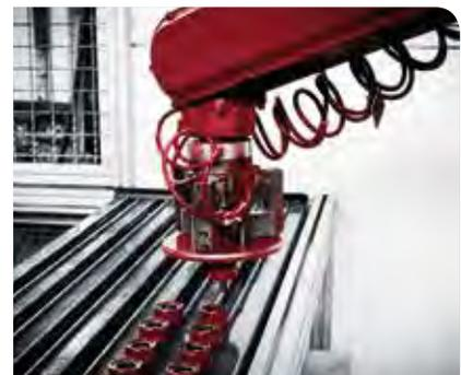
Der Roboter legt das beschichtete Werkstück zuverlässig auf einer bereitgestellten Unterlage ab.
