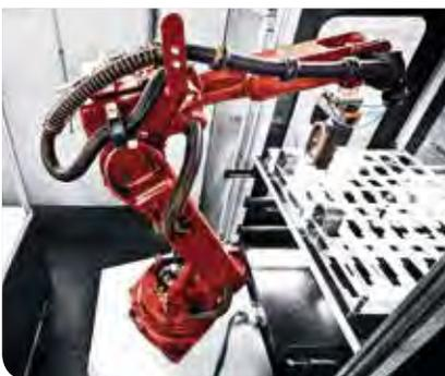
Mit seinem druckluftgesteuerten Greifer nimmt der Roboter das schwere Kettenglied ohne Probleme auf und transportiert es zuverlässig zum Bandschleifer.
