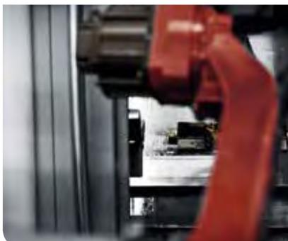
Nach Beendigung des Drehvorgangs entnimmt der Roboter mit einem Greifer das fertige Werkstück, dreht den Greifer um 180° und bestückt das Drehfutter über den zweiten Greifer mit dem Rohling.
