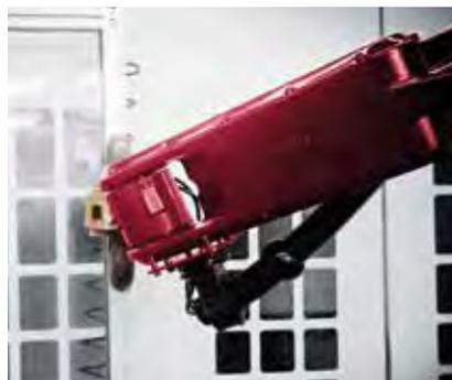
Das gefräste Bauteil wird zunächst in einer Halterung zwischengelagert, um mit der Aufnahme eines Rohlings zuerst den zeitaufwendigen Fräsprozess zu bedienen.
