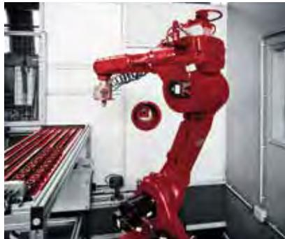
Die speziell an das Pulverbeschichten angepasste Standard Robot Cell garantiert nicht nur eine gleichbleibend hohe Qualität der Beschichtung bei optimaler Nutzung des Pulvermaterials, die Robotereinheit erfüllt außerdem auch den geforderten Explosionsschutz dank des extra angefertigten nicht leitenden Greifers.
