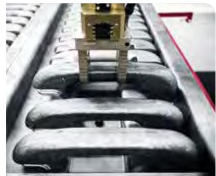
Nach dem Entgraten legt der Roboter das Werkstück auf der Palette ab.
