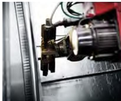
Der Doppelgreifer entnimmt zunächst den fertigen Wirbelkörper mit dem freien Greifer und bestückt dann das Drehfutter mit dem Rohling aus dem zweiten Greifer.
