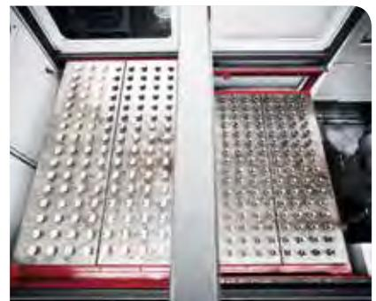
Die Steuereinheit der Robot Cell registriert wenn alle Rohlinge einer Palette bearbeitet sind und veranlasst automatisch einen Palettenwechsel. Der Produktionsprozess kann ohne Unterbrechung fortgesetzt werden.
