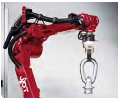
Der kompakte und schmale Körper des 6-achsigen Hochgeschwindigkeitsroboters ist für verschiedene Traglasten erhältlich. Mit Hilfe der Servo-Float-Funktion können Anfahrpunkte zudem weich angesteuert werden.
