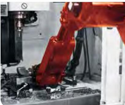
Der Roboter transportiert den Rohling auf kürzestem Wege zur Fräsmaschine und platziert das Werkstück exakt in der Spannvorrichtung.
