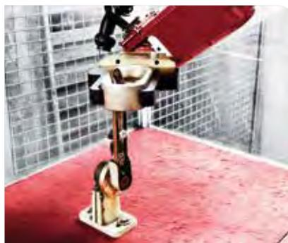
Mit exakt den gleichen Bewegungen führt der Roboterarm das Kettenglied gleichmäßig um den Bandschleifer und produziert so immer die gleich hohe Qualität beim Entfernen des Schmiedegrats.
