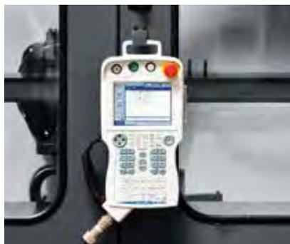
Die ergonomische Teachbox erleichtert mit einer benutzerfreundlichen Menüführung und seiner einstellbaren Bedienoberfläche die Programmierung des Roboters.
