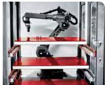
Spezielle Führungsschienen sorgen für eine positionsgenaue Bereitstellung der Werkstücke auf drei Palettenebenen. Der automatische Palettenwechsel versorgt den Roboter kontinuierlich mit Rohlingen.
