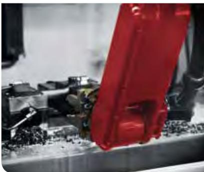
Nach dem Fräsen reinigt der Roboter das Werkstück mit Druckluft und entnimmt es aus der Spannvorrichtung der Fräsmaschine.
