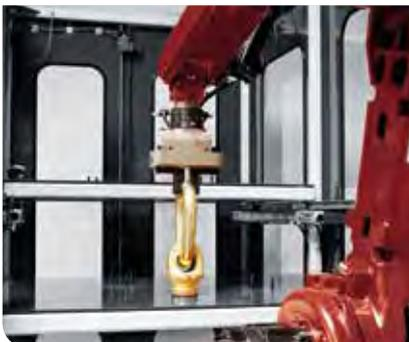
Der auf das Werkstück abgestimmte Greifer nimmt das zu montierende Bauteil sicher auf.
