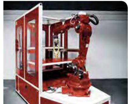
Das Montieren von Bauteilen ist eine Standardanwendung für Industrieroboter. Mit der Flexible Robot Cell haben wir eine mobile und wirtschaftliche Automationslösung entwickelt, die einfach und schnell an unterschiedlichen Orten von Fertigungsprozessen – u. a. zur Montage von Bauteilen – eingesetzt werden kann.
