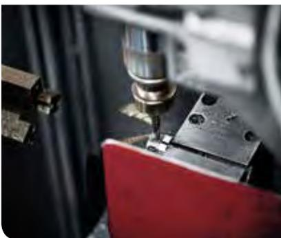
... eine Bohrung in das Gehäuse eingebracht ...
