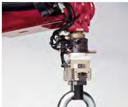
Das Teilehandling kann mit speziell geformten Greiferbacken individuell auf jedes Werkstück angepasst werden. Ein praktisches Schnellwechselsystem erlaubt zudem den manuellen oder automatischen Austausch des Greifermoduls.
