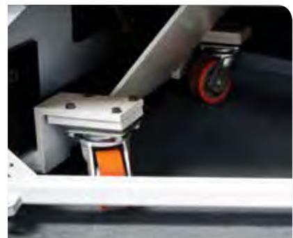
Stabile Lenkrollen ermöglichen einen problemlosen Ortswechsel, während Versteifungsbleche auftretende Verwindungskräfte abführen und damit den Robotersockel stabilisieren.
