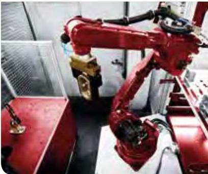
Die Flexible Robot Cell handhabt während des Schleifens mühelos schwere Werkstücke und produziert ausdauernd reproduzierbare Qualität auf höchstem Niveau. Mit dem Einsatz von Robotern schützen wir unsere Mitarbeiter vor großer körperlicher Belastung und den Gesundheitsgefahren durch Schleifstaub.
