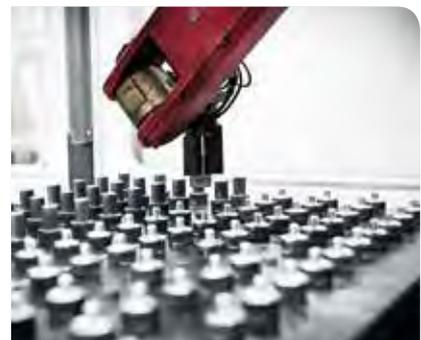
Der Doppelgreifer positioniert sich exakt über dem Rohling auf der Palette und nimmt ihn mit dem per Druckluft gesteuerten 3-Backen-Greifersystem auf.
