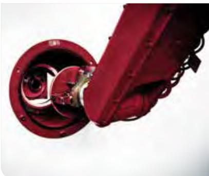
... führt das Werkstück auf kürzestem Wege zum Beschichter und platziert es zuverlässig immer an exakt derselben Position.
